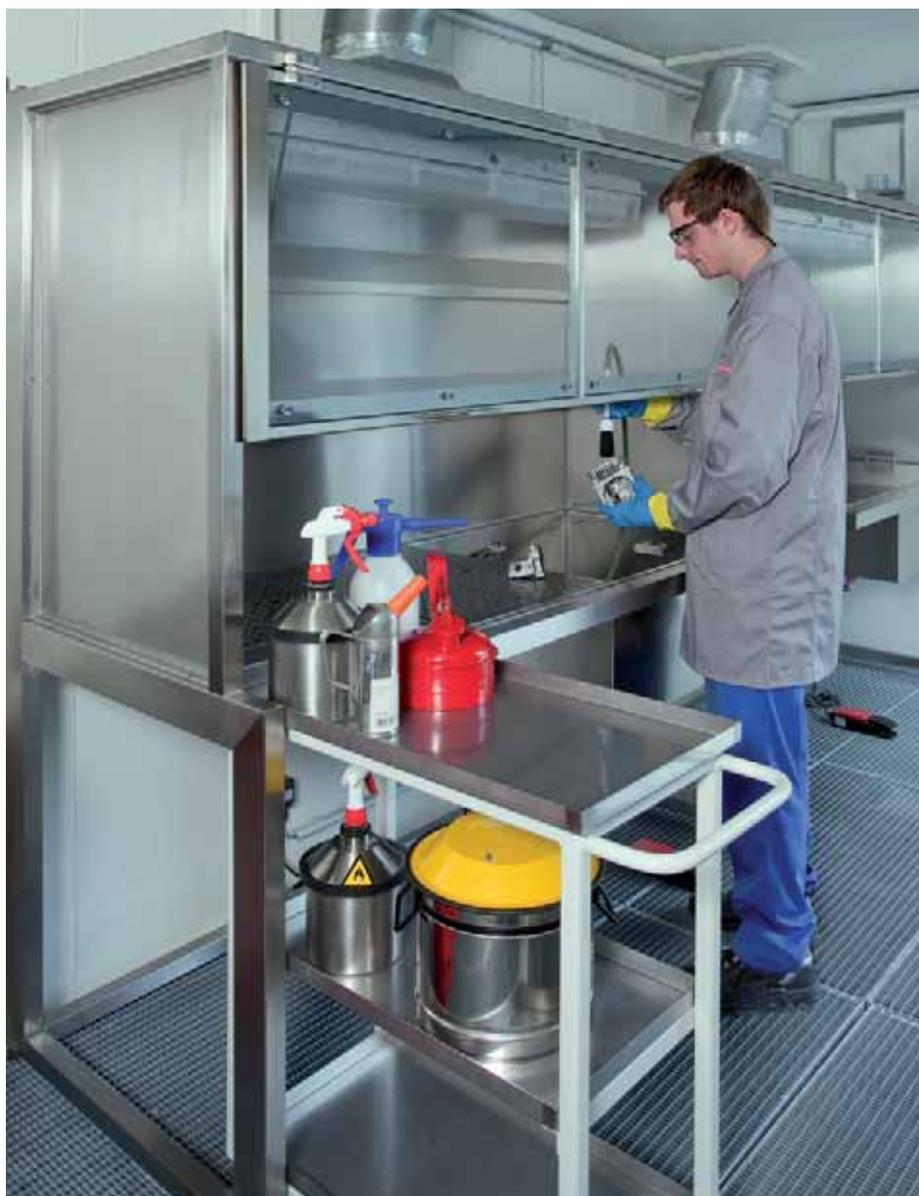
Abb. 3: Absaugtische im Mischcontainer
