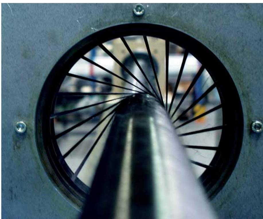
Abb. 6: Faserwickelmaschine (Schunk Composites-Fertigung) – Wickelprozess mit Ringfadenaug für hochpräzise, rationelle Serienproduktion; Zuführung der Fasern über externes Leitsystem
