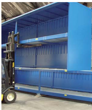
Montage des 3P814 mit fertig montiertem Container-Oberteil. Der Aufbau des gesamten Lagers erfolgte in zwei Teilen.
