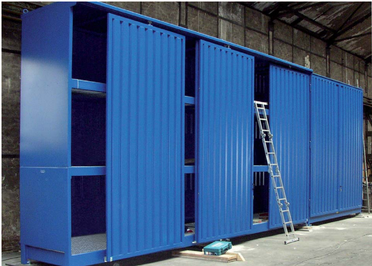
Maßgeschneiderte Gefahrstofflager-Kombination aus zwei System-Container-Typklassen: 3P814 und 3P414.
