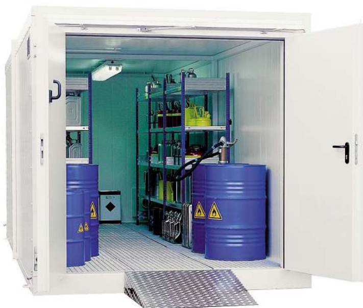
Bild 2: Mobiler Brandschutzmodulcontainer, ausgerüstet mit einer Lüftungsanlage für 5-fachen Luftwechsel pro Stunde mit Atex-Bescheinigung.
