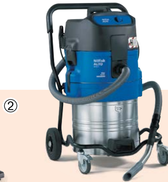
Sicherheitsauger Typ S 560-Asbest mit 3-m-Saugschlauch (Ø 36 mm), gebogenem Edelstahl-Handrohr, Filtersack und -element, Schrägröhrdüse und Gerätesteckdose.
