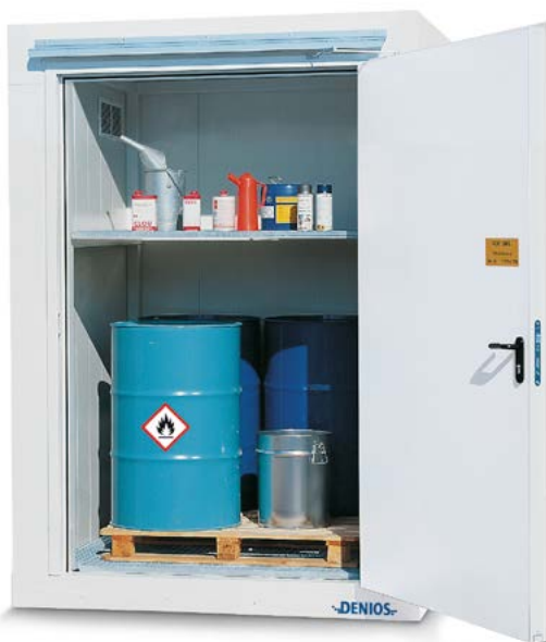
Brandschutzlager BMC-S 180-4 mit EI90-Tür, für 4 Fässer à 200 Liter und Regal für Kleingebinde (optional)
