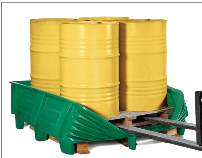
Die Frontseite der Sicherheitswanne lässt sich mittels Gabelstapler herunterdrücken, so dass sich Fässer auf einer Palette stehend ein- und ausladen lassen.
