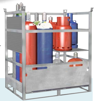
④ Stapelbare Gasflaschenpalette Typ GFP-33.11 mit 2 Lagerebenen für bis zu 12 Gasflaschen, Ø 320 mm.
