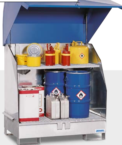
Gefahrstoffdepot Typ 2 GST-KS, verzinkt, Regal mit 1 x Gitterrost ganze Breite, für Kleingebinde und 60-Liter-Fässer
