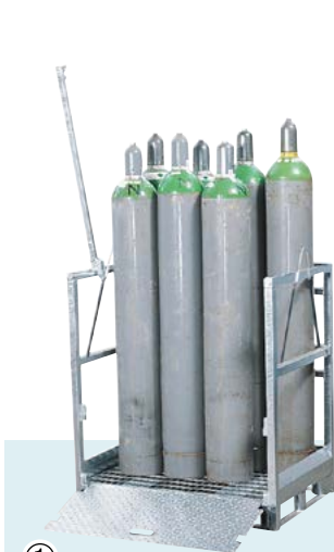
① Kranbare Gasflaschenpalette Typ GFP-50 für bis zu 12 Gasflaschen, Ø 230 mm, mit Schwenkbügel
