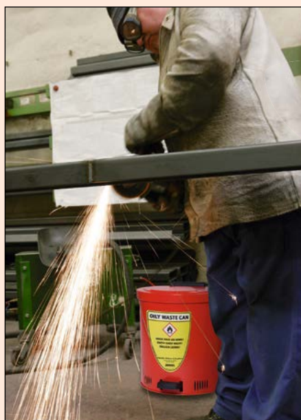
Der selbstschließende Deckel verhindert ein Entzünden des Inhalts, z. B. durch Funkenflug.
