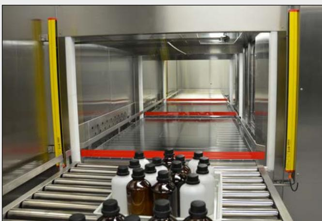
Materialluftschleuse mit Sprühtrocknungssystem zur IPA-Desinfektion
