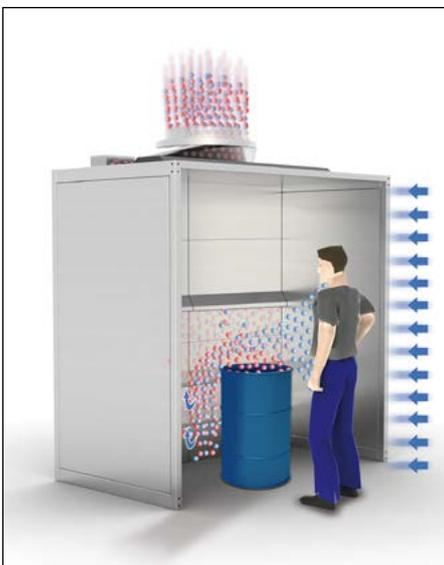
Die angewandte Absaugtechnologie (horizontale Verdrängungsströmung) sorgt für eine gerichtete Luftströmung von der Eintrittsöffnung der Anlage in Richtung Absaugleisten. Dabei wird über den freien Querschnitt an der Eintrittsöffnung eine Luftgeschwindigkeit von ca. 0,5 m/s sichergestellt.
