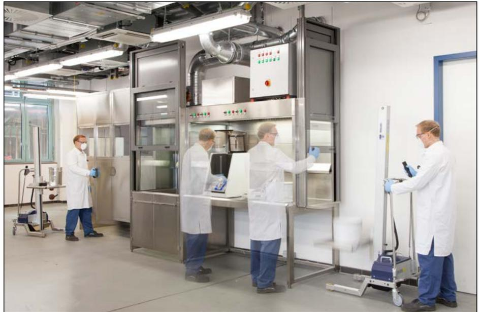
Der Intensivmischer steht in einem Freiarbeitsplatz mit Flügeltüren, die nicht nur den Mitarbeiterschutz erhöhen, sondern auch den Geräuschpegel des Mixers reduzieren.
