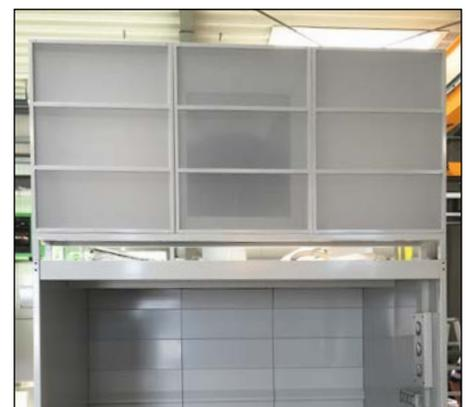
Umluftplenum zur Rückführung der gefilterten Luft in den Raum
