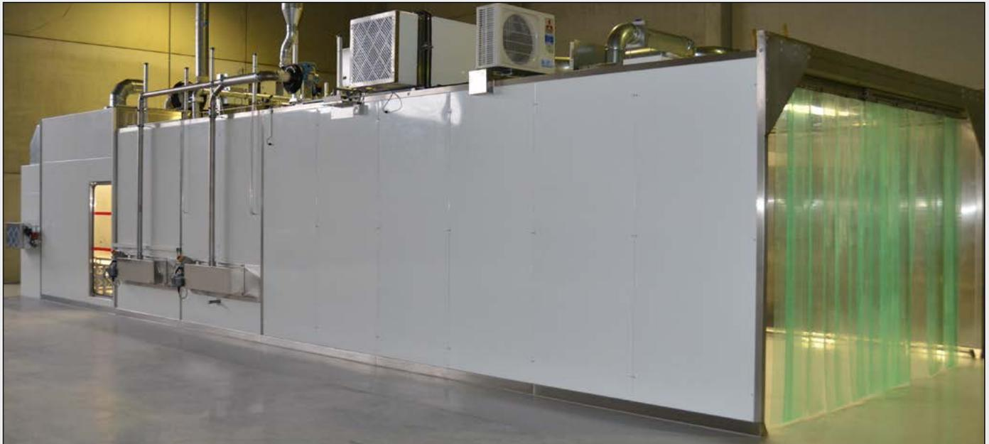
Probenahmen-Anlage mit Materialdurchreiche, Hubanlage, Personalschleuse, Materialschleuse mit automatischen Förderbändern und Probenahmen-Freiarbeitsplatz – inklusive automatischem IPA-Desinfektionsbereich
