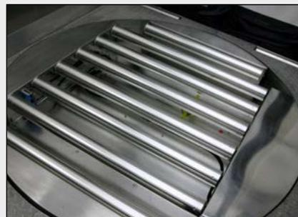
**Paletten-Drehtisch**, ein in den Boden eingelassener Edelstahl-Schwerlast-Tisch; wird über den HMI-Bildschirm im Innenraum gesteuert und ist mit dem Hauptförderbandsystem verbunden.
