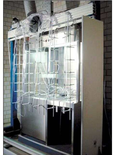
**VARIO-Flow Arbeitstisch (Typ Premium) im Prüfaufbau für die Ermittlung des Rückhaltevermögens**
