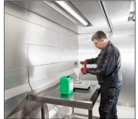
Arbeitstisch, zum höheren Personenschutz ebenfalls an das Ejektorsystem angeschlossen
