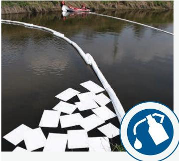
DENSORB ÖL hat die Besonderheit, Öle aufzunehmen und Wasser abzuweisen. Öl wird aufgesogen, ohne ein Tröpfchen Wasser aufzunehmen. Für Öle, Benzin, Diesel, Lösungsmittel, Petroleum (Flüssigkeiten auf Kohlenwasserstoffbasis)
